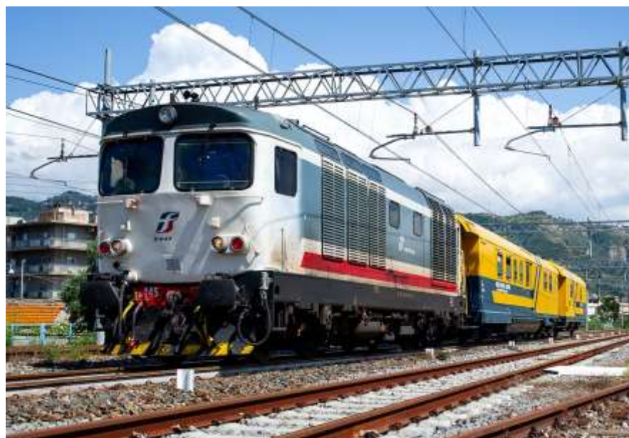
"Treno di soccorso nella composizione tipica, locomotiva diesel e carri attrezzati"
